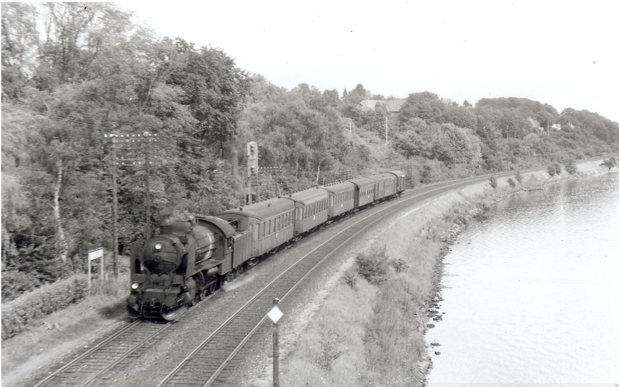
Næh – må vi lige få et ordentligt oprangeret tog her! Ja, se bare den stamme, som R maskinen suser afsted med - det er da stilrent! Efter maskinen er det en ARM, CM og en AR, alle spidsgavlede, derefter følger en CQM, DC post/rejsegodsvogn og endelig en HD godsvogn. Toget har netop passeret I-signalet til Kolding i 1961.
