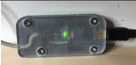
Boks med elektronikken til Speed-Cat. Den er forbundet til PC'en hvor der er installeret Windigipet med et USB-kabel.
