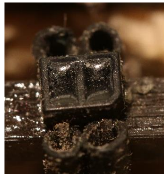
28 ITR8307 "rå" og monteret på en svelle. - Foto: MJK Limfjorden
