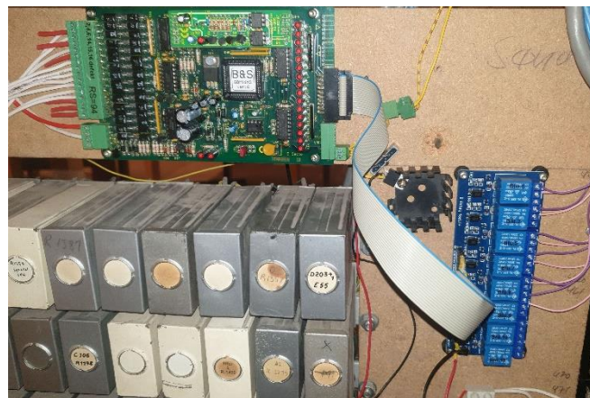
5 - Alb: Kobling mellem M.29 relæer på Be sikringsanlæg og Blücherkort samt moderne relæer til sporbesættelse til højre – Foto: J. Bertelsen, DMJK
